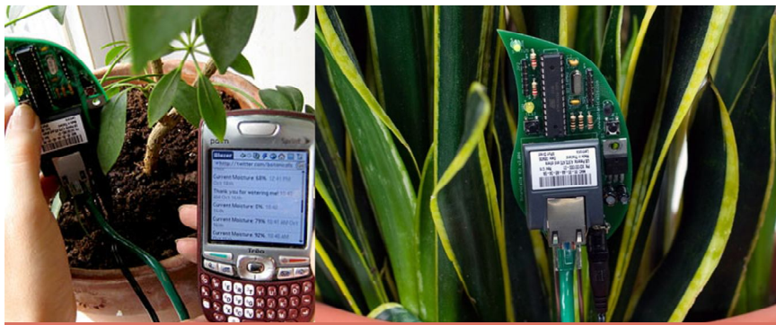
Figura 2: HARMAN, Kate. Botanicalls ,2009. Sistema composto por sensores de umidade conectados a uma placa de circuito que envia mensagens para o Twitter.
